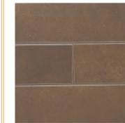
本製品は横目地を6mmで施工することで、縦横6mmの目地ができるように設計されています。組積後は、市販のタイル用目地材、もしくはコーキング材でタイル目地部を埋めていただき、美観性の向上とブロック内部への雨水等の侵入を極力防ぐよう施工していただくとともに、ブロックの天端部には笠木を施工してください。
