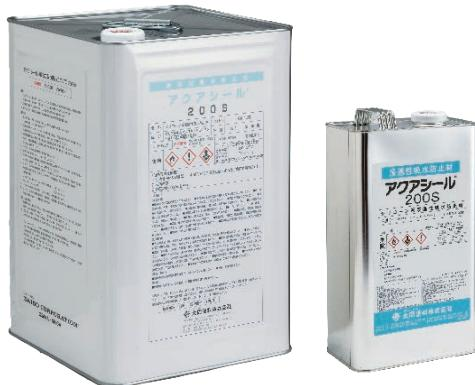
アクアシールは、コンクリートブロック塀を美しく保つ吸水防止剤です。ブロックの内部に深く浸透し、化学反応によって強力な厚い防水層を形成しますので、長期間、水の浸入を防ぎます。また、耐アルカリ性や、塩害・凍害・酸性雨害および白華防止にも優れています。コンクリートブロックやれんがはもちろん、吸水性の高い素焼タイル・天然石など、さまざまな素材の色や風格を、そのままに保つことができます。
