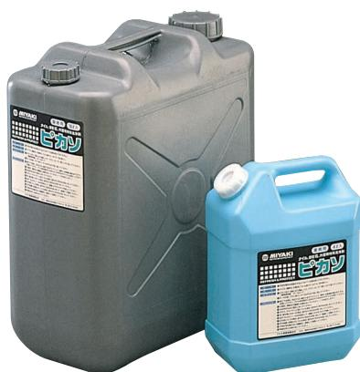
ピカソは、石材・タイル・外壁材に付いた錆(サビ)や水アカ・雨じみ等の強力な汚れ落としに効果的な洗剤です。施工面全体を水で濡らし、汚れに応じて原液～5倍希釈液をハケ等で均一に塗布してください。3～5分放置後、ブラシ等でこすりながら水洗いし、薬品が残らないように洗浄してください。
