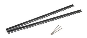
エッジプロ・ノバは、インターロッキングブロックと芝生やグランド カバー、植え込みとの間に、きれいな境界線をつくる新しい見切り材 です。これからの公園づくりや街の景観整備に素晴らしい効果を 発揮します。インターロッキングブロックの重さを利用してエッジング 自体を動かないように固定します。曲線で使用する場合は、定着 プレートのリンク部を切断してください。曲線の場合は本体1本に 付き、スパイクピンを6本使用してください。
