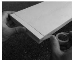
接着剤(ペグα)を本体に塗布してエンドキャップを取り付けます。接着剤が硬化するまでマスキングテープでエンドキャップを固定します。接着剤の塗布方法については、接着剤の取扱説明書に従ってください。
