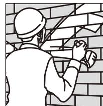
屋外に使用した場合は、通風、直射日光を避けシート張りなどで1週間以上養生した後、吸水防止剤(SBマックスB-200/WTS512/ア ク アシール200Sなど)を塗布してください。
