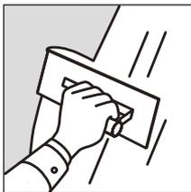
プライマー処理をした下地に、モルタルを塗り厚3mm以上になるようにしごき塗りします。一度に塗る面積は、オープンタイム30分以内にブリックを貼り終える面積にします。
