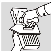
ブリック裏面にプライマー処理、または十分な水浸しをします。ブリック裏面にモルタルを塗り付け、裏溝にも必ずしっかりとモルタルを塗り込んでください。
